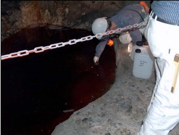
Photo 56: 750-m-Sohle, Probenahme MP SK (Laugesumpf bei Sprengstoffkammer)
