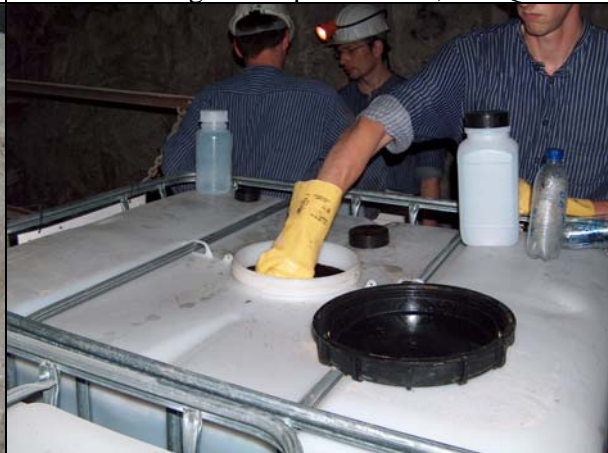
Photo 43: Probenahme MP QN aus dem rechten Transportbehälter (1 m 3 )
