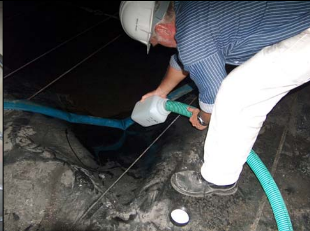
Photo 15: Füllen Probengefäße SB1-PN über den Schlauch der Verbindungsleitung
