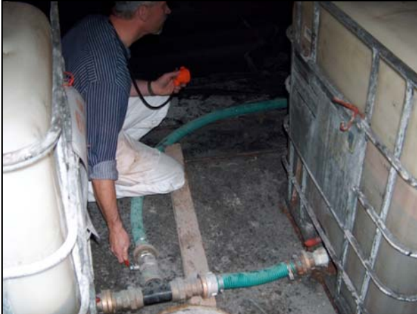
Photo 14: Probenahme SB1-PN aus 2 Behältern mit je 1 m 3 über Verbindungsleitung
