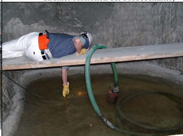
Photo 31: Probenahme Zutrittslösung am MP 38; direktes Füllen der Probebehälter
