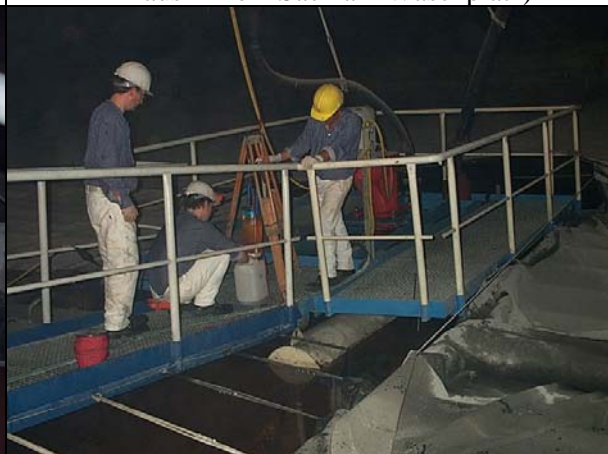
Photo 19: Probenahme SB2u (Speicherbecken 2 auf 490-m-Sohle) mit Schöpfgerät
