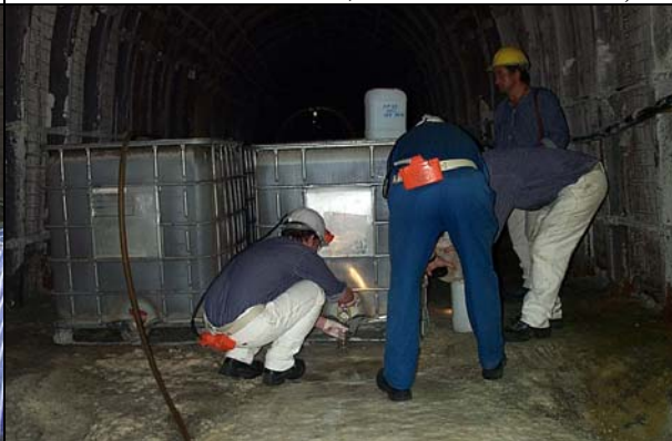
Photo 35: Probenahme MP 39 aus Transport- behälter (1 m 3 ) über Ablaufstutzen
