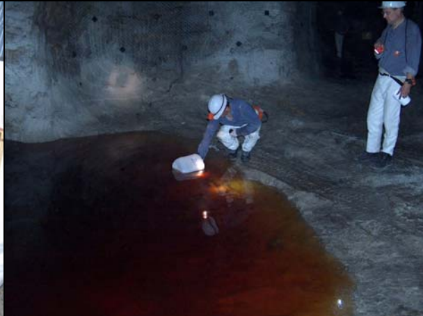
Photo 57: 750-m-Sohle, Probenahme MP RS (Reicheltsumpf)
