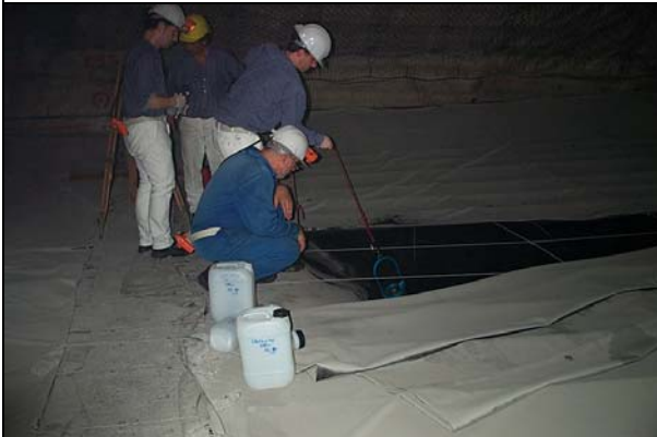
Photo 09: Probenahme SB1ho mit Schöpfgerät
