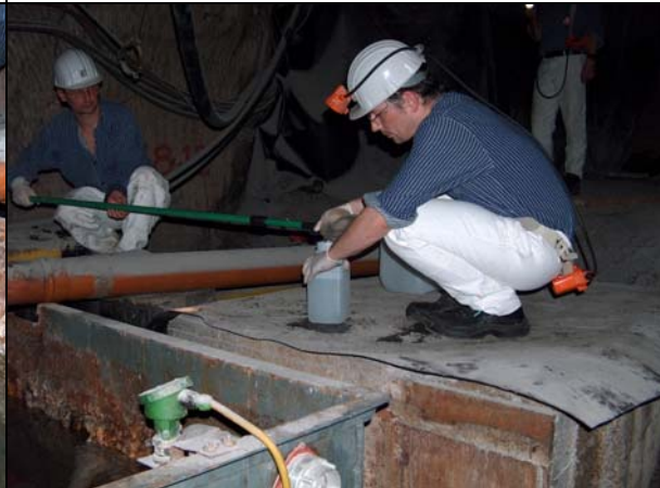
Photo 23: Füllen von Probebehälter 2,5-Liter am MP 27-Z
