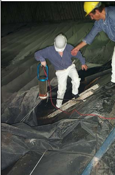
Photo 11: Probenahme SB1vu mit Schöpfgerät
