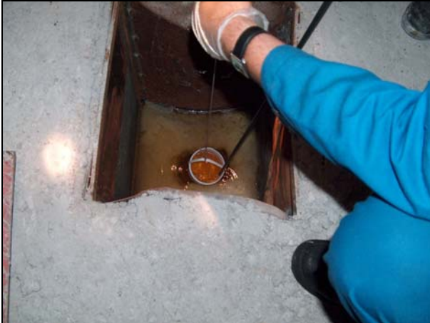
Photo 62: Vorgehensweise Probenahme MP L2 (Schritt 2 – Entnahme gefüllter Eimer)
