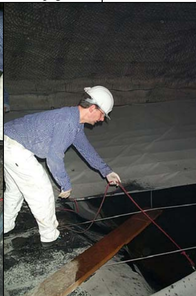
Photo 12: Probenahme SB1hu mit Schöpfgerät
