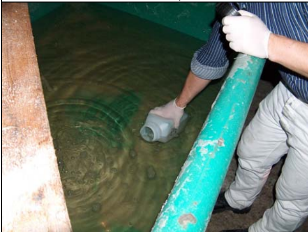
Photo 40: Probenahme MP RL2; Entnahme aus Auffangbehälter
