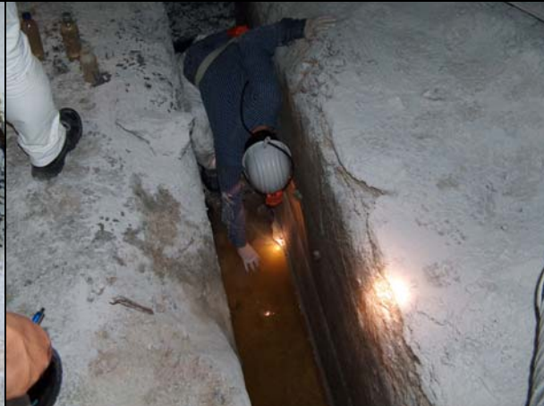
Photo 45: Probenahme aus Sohlenschlitz MP L6
