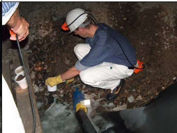
Photo 25: Entnahme Feststoffproben K3/658-F# hinter Zulauf Kammer 3 658-m-Sohle
