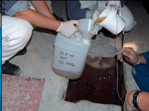
Photo 63: Vorgehensweise Probenahme MP L2 (Schritt 3 – Füllen der Probengefäße)
