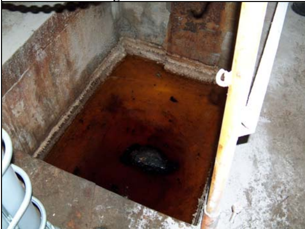
Photo 42: 750-m-Sohle; Laugesammlung in Sohlenschlitz MP QN
