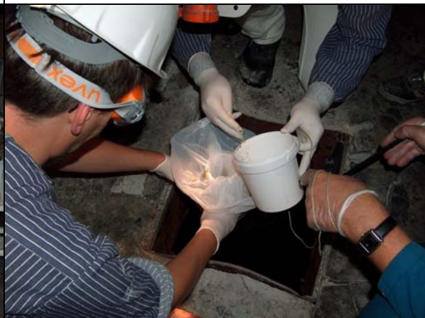
Photo 67: Entnahme Feststoffprobe MP L3-F (Salz/Bodensatz)
