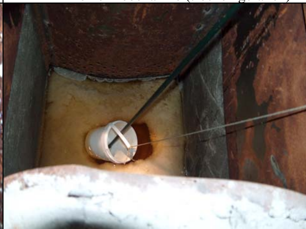
Photo 61: Vorgehensweise Probenahme MP L2 (Schritt 1 –Eintauchen eines Eimers)
