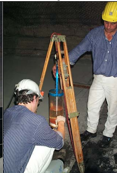
Photo 13: Füllen Probengefäß aus Schöpfgerät
