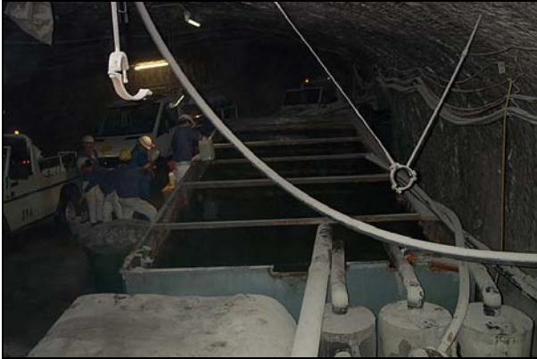
Photo 20: Sammelbehälter (40 m 3 ) auf 658-m-Sohle vor Kammer 3 (MP 27-S)
